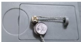
Sellado mediante cable
