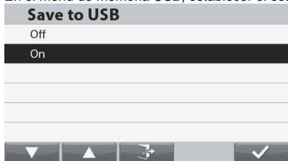
Mediante la conexión de una unidad flash USB a la escala de las lecturas de peso ahora pueden almacenarse directamente en la unidad flash USB.
