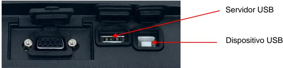
La interfaz del dispositivo USB de Ohaus es una solución única al problema de la conexión de la báscula a un ordenador utilizando un bus serial universal (USB). Los dispositivos USB están categorizados en clases como unidades de disco, cámaras digitales, impresoras, etc. Las básculas no tienen una clase que suelen utilizar; por lo tanto, la interfaz USB de Ohaus utiliza una interfaz genérica basada en el estándar serial RS232.
