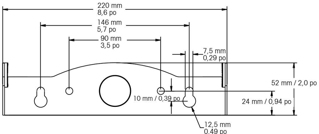
Figure 2-6. Dimensions des supports de montage.
